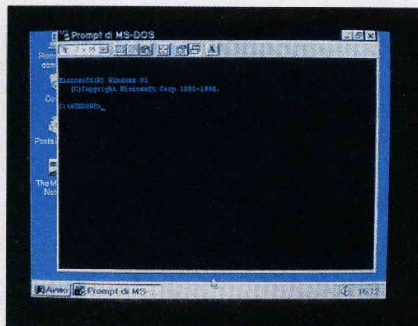
Fig.9 Scrivete C:\WINDOWS>CD\ poi premete Enter e così apparirà sotto questa riga il prompt C:\> .
