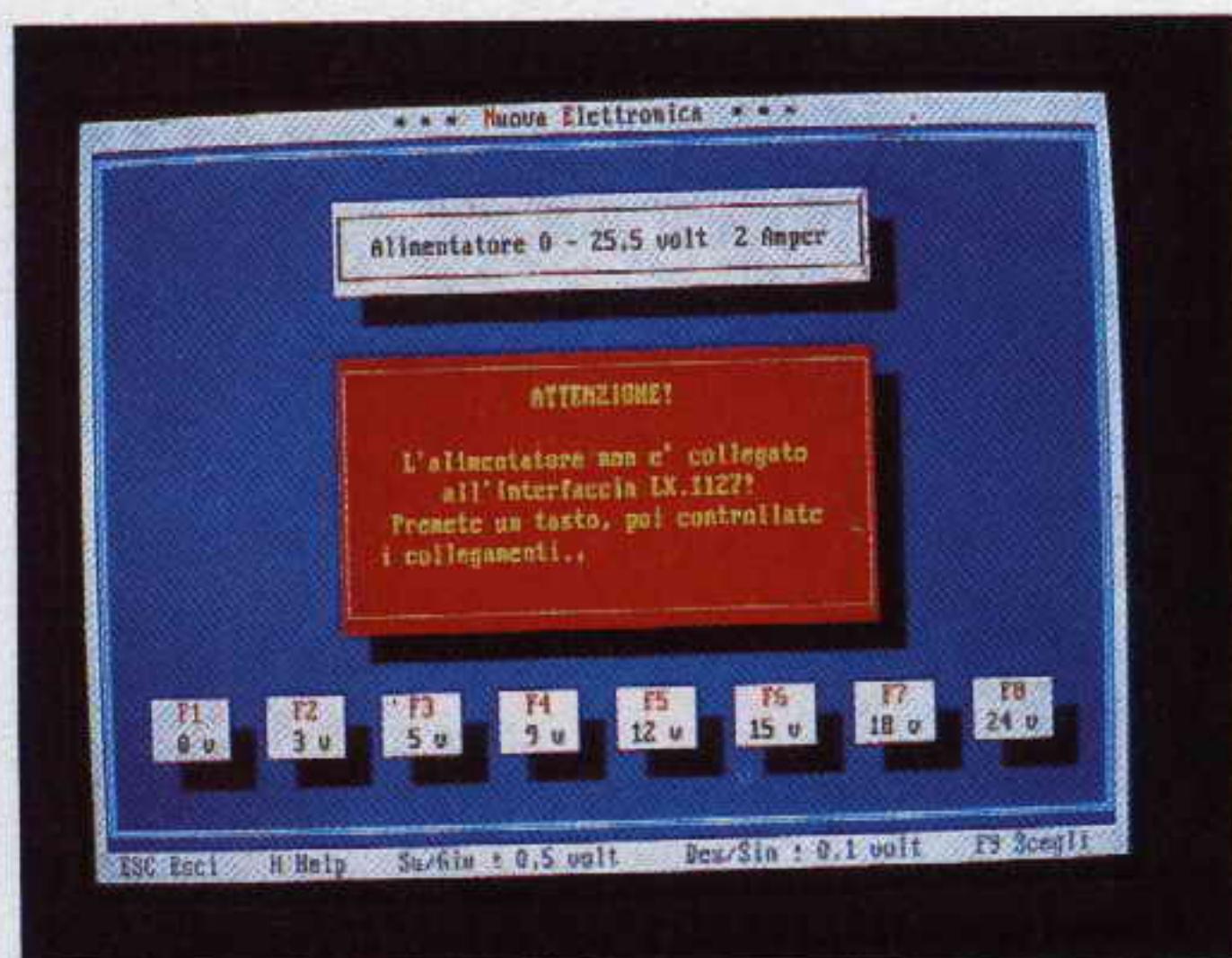
Fig.22 Se sul monitor appare questa scritta significa che non avete collegato l'alimentatore all'interfaccia LX.1127.
