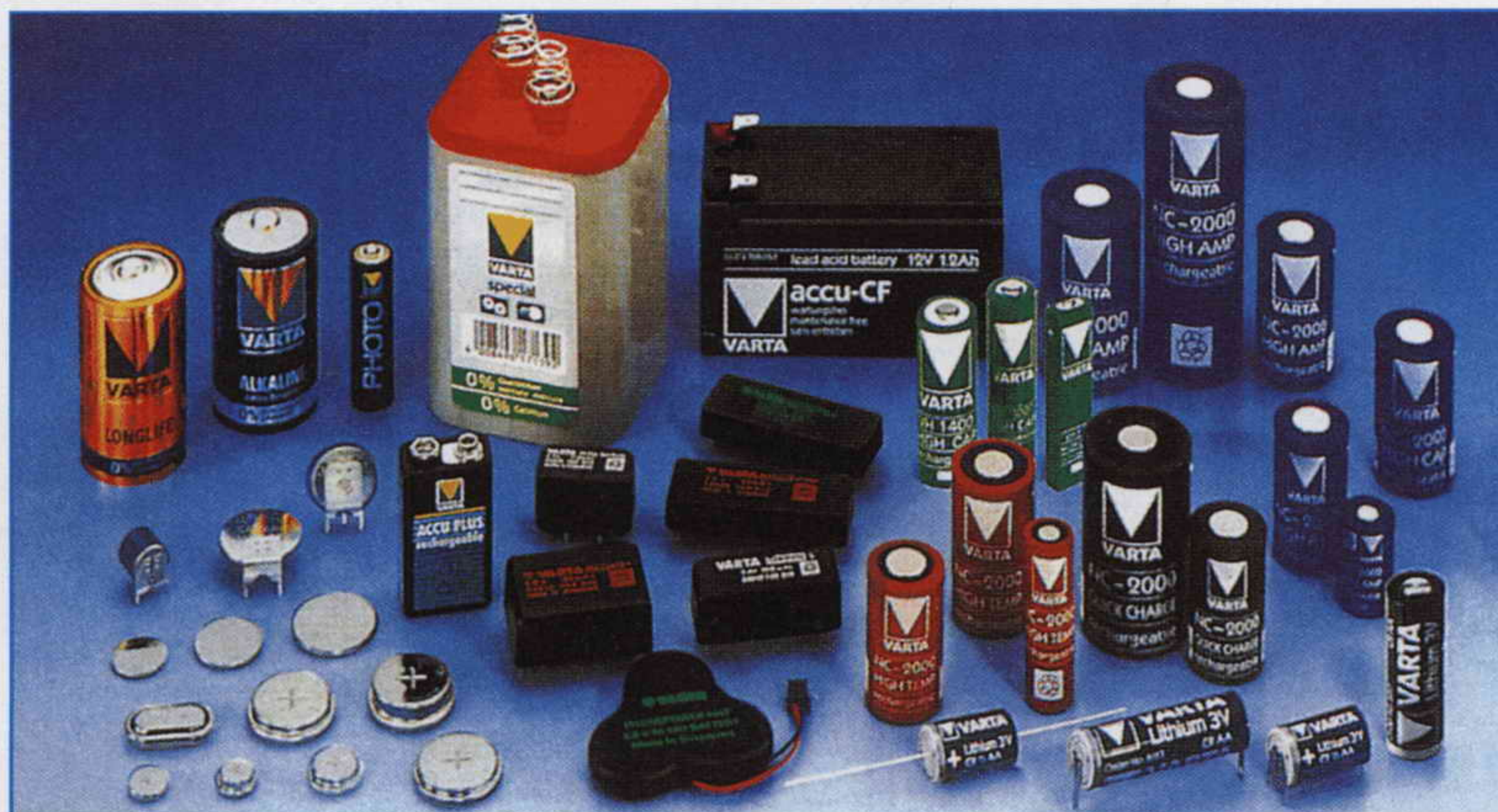
Fig.37 In commercio possiamo trovare pile con tensioni e dimensioni diverse. La capacità di una pila viene espressa in Amperora. Una pila da 3 Ah si scarica in un'ora se preleviamo 3 Amper, in due ore se preleviamo 1,5 Amper ed in trenta ore se preleviamo 0,1 Amper.
