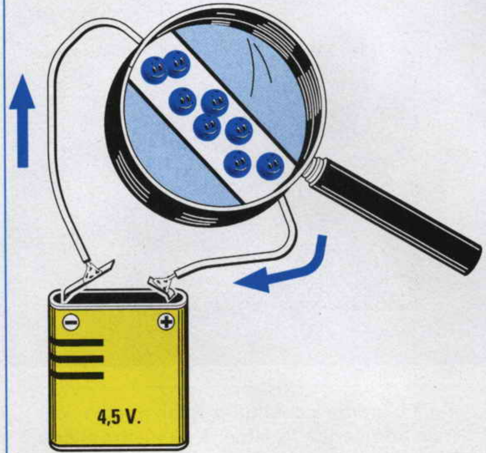
Fig.10 Gli Elettroni vengono attirati dai Protoni quindi il flusso della corrente elettrica va dal negativo verso il positivo.
