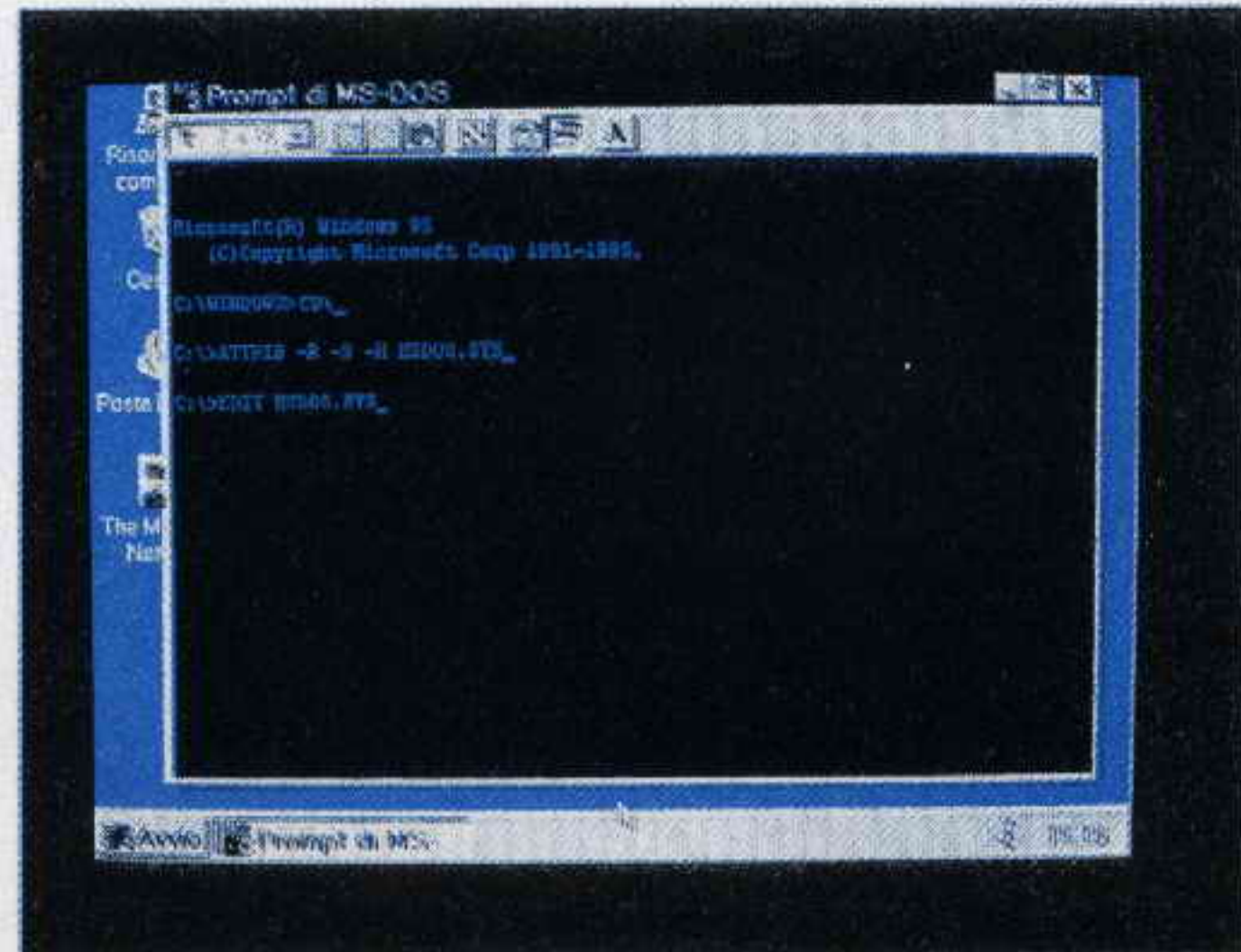
Fig.10 Rispettando le spaziature digitate la scritta ATTRIB -R -S -H MSDOS.SYS poi premete Enter.
